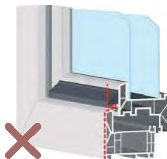
flächenversetztes Fenster mit Wetterschenkel
