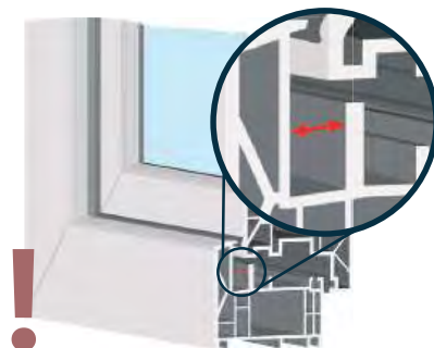
Mitteldichtung: Abstand mind. 12 mm
